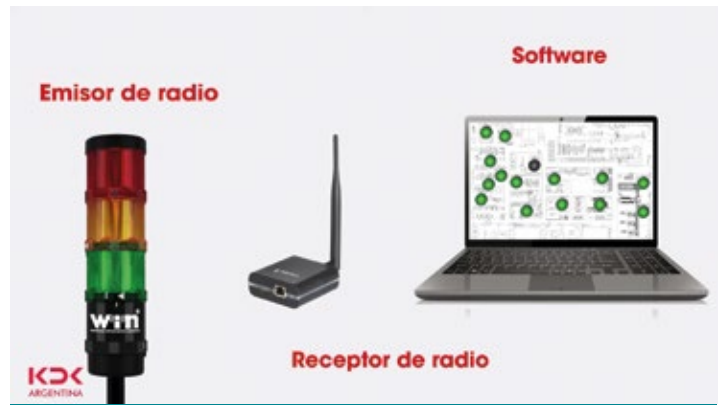
Elementos que componen SmartMonitor Fuente: KDK Argentina
