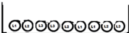
Figura 1. Ejemplos de geometría de montaje de cables enterrados de manera correcta e incorrecta en cuanto a la tipología de los cables.
