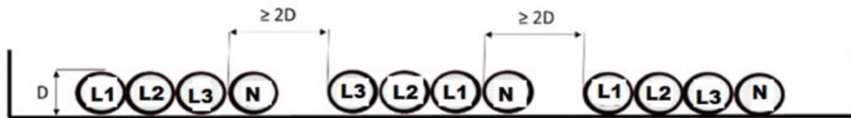
Figura 2. Ubicación correcta de neutros
