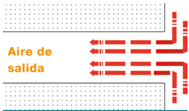
Figura 4. En las salidas de aire de escape se succiona el aire desde todas las direcciones. Para generar una corriente de aire que se pueda medir es necesario utilizar un cono.
