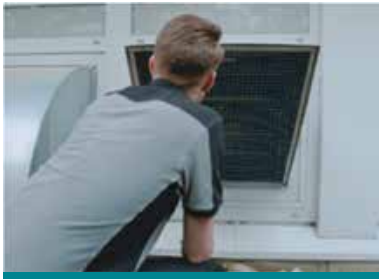
Figura 1. a) Si se cubre la salida de aire con el cuerpo, se modificará la resistencia del caudal y de este modo se distorsiona el resultado de medición.
