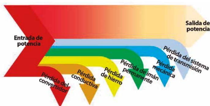
Figura 5. Diversos componentes de pérdida de una máquina eléctrica utilizada en el sistema de propulsión de vehículos eléctricos
