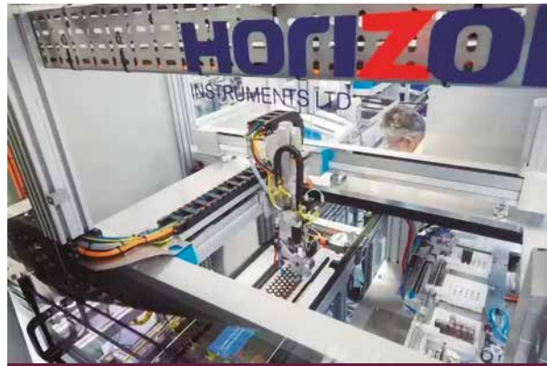
El especialista en soluciones de automatización, Horizon Instruments, se hizo cargo del diseño e integración del pórtico horizontal de dos ejes de Festo.
