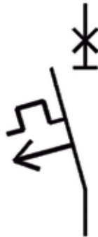
Figura 1. Interruptor termomagnético automático bipolar (izq) | Figura 2. Símbolo unipolar (der).
