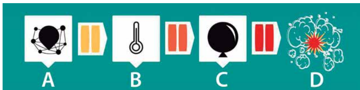
Figura 2. Qué ocurre si el aumento de temperatura de la batería no se controla convenientemente:
