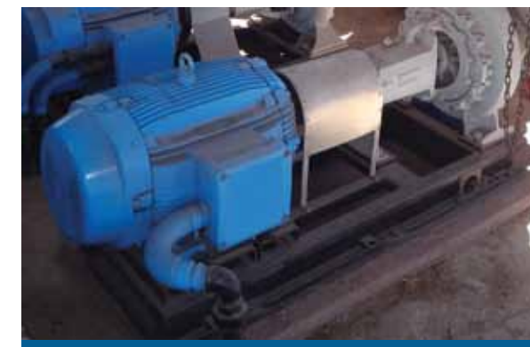
Figura 1. Caso típico de un MET acoplado a una bomba centrífuga
