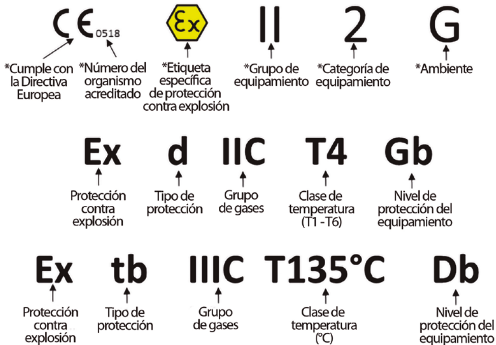
Figura 5. Ejemplos de etiquetas ATEX/IECEx
