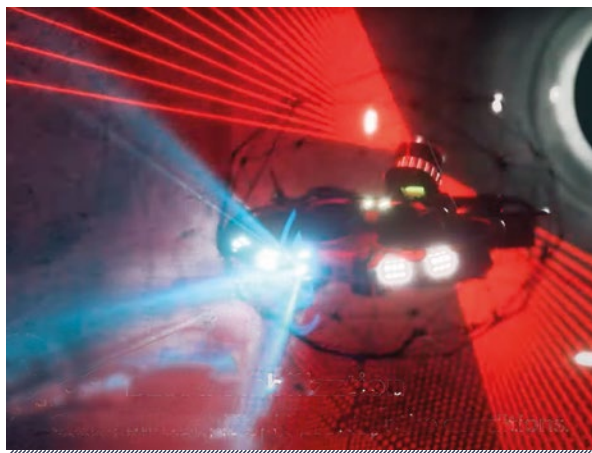
Figura 3. El dron Elios-3 utilizando su sistema LIDAR
