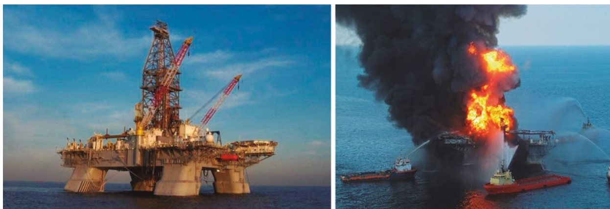
Figura 2. Plataforma DeepWater Horizon. A la izquierda, vista general de la enorme plataforma semisumergible con anclaje dinámico, y a la derecha, intento de extinción del incendio horas antes de que la plataforma se hundiera definitivamente.
