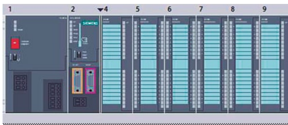
Figura 2. PLC y módulos de expansión
