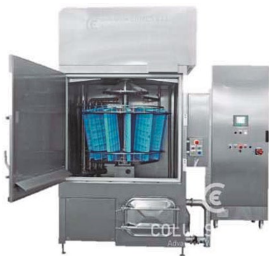
Figura 1. Lavadora rotativa de moldes industrial
