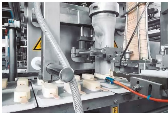
Posicionamiento perfecto: el núcleo de los helados Magnum sale de la extrusora a gran velocidad. Durante el proceso de extrusión, se inserta el paliillo.
