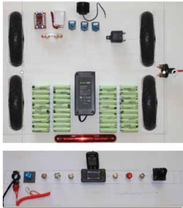
Figura 1. Procedimientos ingenuos de diseño. A falta de otros recursos, se hicieron varios esquemas sobre cartones en escala 1:1 para planificar la distribución de componentes. El primero es un mock-up/fotomontaje de la plataforma principal; el segundo corresponde al pórtico de comando. Seguramente un puesto de trabajo CATIA habría sido excesivo, pero AutoCAD 3D habría sido una buena herramienta para este proyecto.
