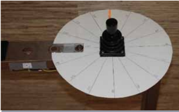
Figura 6. Super goniómetro. Puede parecer algo precario, pero este fue el disco que usé para tratar de correlacionar "donde apunta" la palanca de control vs. el radio efectivo de giro.
