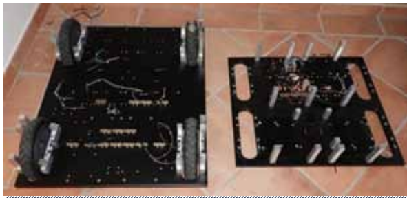
Figura 7. Comparación visual de bases. Derecha: primera versión, con geometría corta (trocha superior a la distancia entre ejes). Izquierda: segunda versión, con geometría cuadrada (trocha similar a la distancia entre ejes). En ambos casos, la trocha se mantuvo en 550 mm
