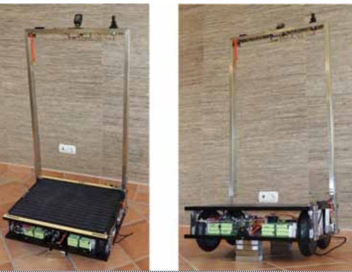
Figura 2. Montaje del ecoPT (primera versión). Izquierda: vista general de la construcción. El panel solar cumple un rol de alfombra en la plataforma que ocupa el conductor. Derecha: vista del espacio entre plataformas. Todos los elementos del tren de tracción, de la alimentación eléctrica y del sistema de control están montados en esta zona. Los cuatro packs de baterías se pueden ver en primer plano. Los suplementos de elevación son solo para los ensayos de rotación de las ruedas.
