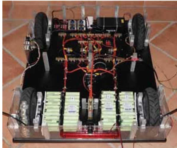
Figura 5. Circuito de potencia eléctrica. Imagen tomada durante el montaje de la segunda versión. En primer plano se ven los cuatro packs de baterías. En el centro está ubicado el interruptor maestro accionado mediante llave y el fusible ultrarrápido. Más atrás se puede ver el contactor de alimentación del circuito de motores (aunque es poco visible debido al bajo contraste). Finalmente se ubican las barras de distribución y, cerca del fin de la plataforma, se encuentran dos placas para elevación de tensión (una para el panel solar y la otra para la alimentación de 12 V desde un vehículo); a su derecha se observa el cargador principal con entrada 220/240 VAC.
