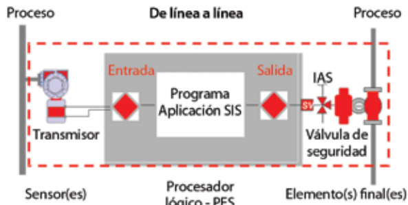
Figura 1. Definición de "sistema instrumentado de seguridad"
