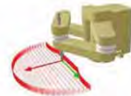
Robot SCARA (del inglés a Selective Compliant Assembly Robot Arm o Selective Compliant Articulated Robot Arm ) es un robot de cuatro grados de libertad con posicionamiento horizontal
