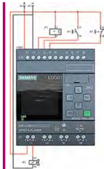
Figura 1. Esquema eléctrico simplificado, donde están representados los órganos que intervienen solo en el cargador de piezas
