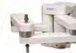
Robot SCARA (del inglés a Selective Compliant Assembly Robot Arm o Selective Compliant Articulated Robot Arm ) es un robot de cuatro grados de libertad con posicionamiento horizontal
